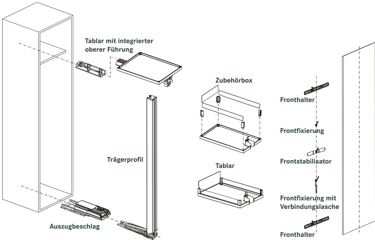
Minimalistisches Design und schwebende Tablare – realisiert durch das neue CONVOY-Trägerprofil.
