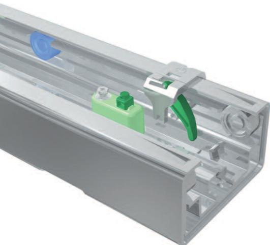
Die innovative **Synchronisierungstechnik** positioniert die Segmente des Beschlags stets „von selbst“ in Nullstellung, unabhängig davon, wie weit und wie oft der Auszug herausgezogen wurde. Ein optimaler Schließvorgang ist somit stets gewährleistet.
